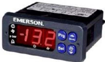
Přístroj EC2-351 je regulátor výparníku s pulzním vstříkovačím ventilem EX2 – řídí přehřátí chladiva. Cílem přístroje je udržování nastavené teploty vzduchu a zajištění odtávání a chodu ventilátoru výparníku.
